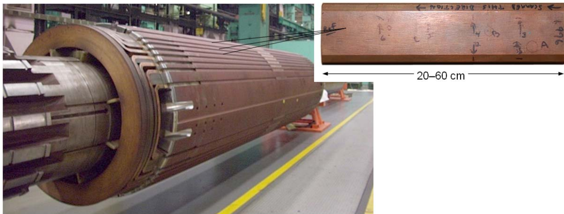
Bild 1. Bild eines Rotors – In einem Schlitz befinden sich viele Rotorwedgen hintereinander
