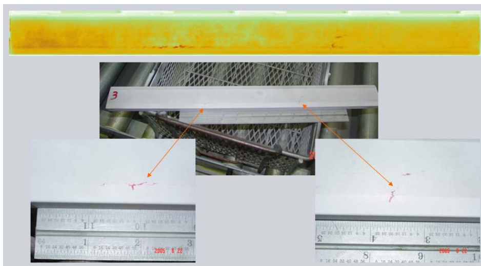
Bild 5. Rotorwedge mit natürlichen Defekten (Rissen)
